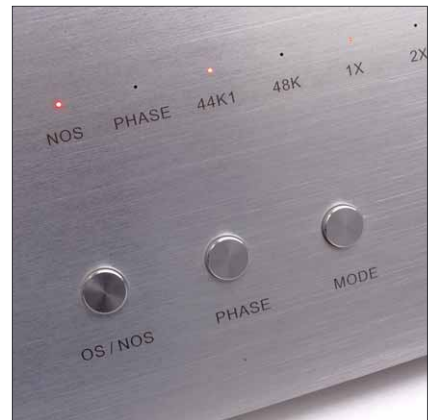
NOS-Modus, Phase und die Pinbelegung der RJ45- und HDMI-Anschlüsse können an der Front eingestellt werden
