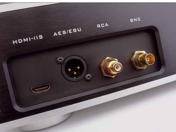
Der HDMI-Ausgang ist für Nutzer eines entsprechenden Wandlers klar die erste Wahl
